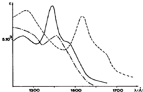
Fig. 1. Vacuum UV absorption spectra of \text{CD}_3\text{ONO} (—), i\text{-C}_3\text{H}_7\text{ONO} (---) and \text{CF}_3\text{NO} (-.-.).
